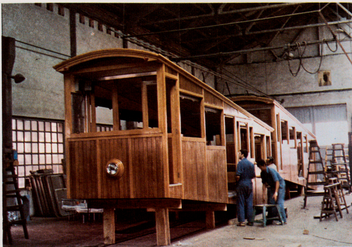
Funicular de Gelida, construcció de noves unitats (Alt Penedès).
